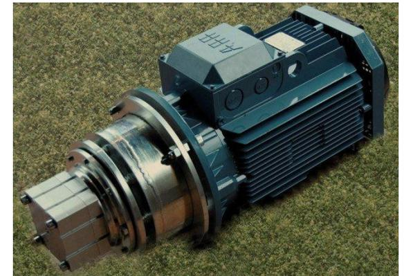
Potencia de 4500N, suficiente para controlar y estabilizar la turbin en cualquier situación. Adaptable para motores asincrono y síncrono.
